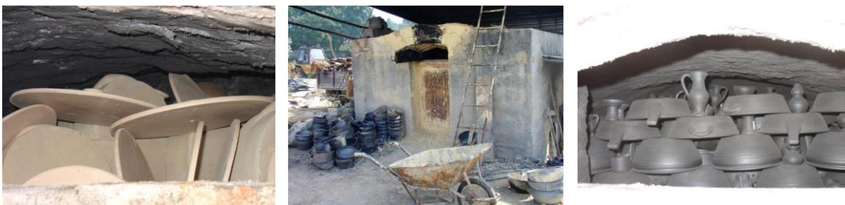
Hoje utiliza-se forno a gás, de grande capacidade, que atinge os 980 – 1020 graus centígrados e cuja entrada de ar é completamente vedada no auge da temperatura para se obter a cozedura redutora. As formas de vedar a entrada de ar no forno têm vindo a evoluir, sendo que os processos actuais utilizam materiais modernos que substituem o barro na vedação da porta do forno.
